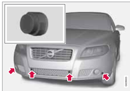
Emplacement des capteurs avant.
