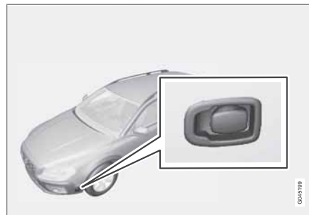
Prise électrique du chauffe-moteur.
